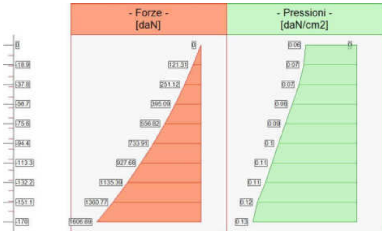
Forze (totali) e Pressioni lungo il fusto, per il Caso 8 ( FREQ. [ Frequente ] - SLE frequente )
