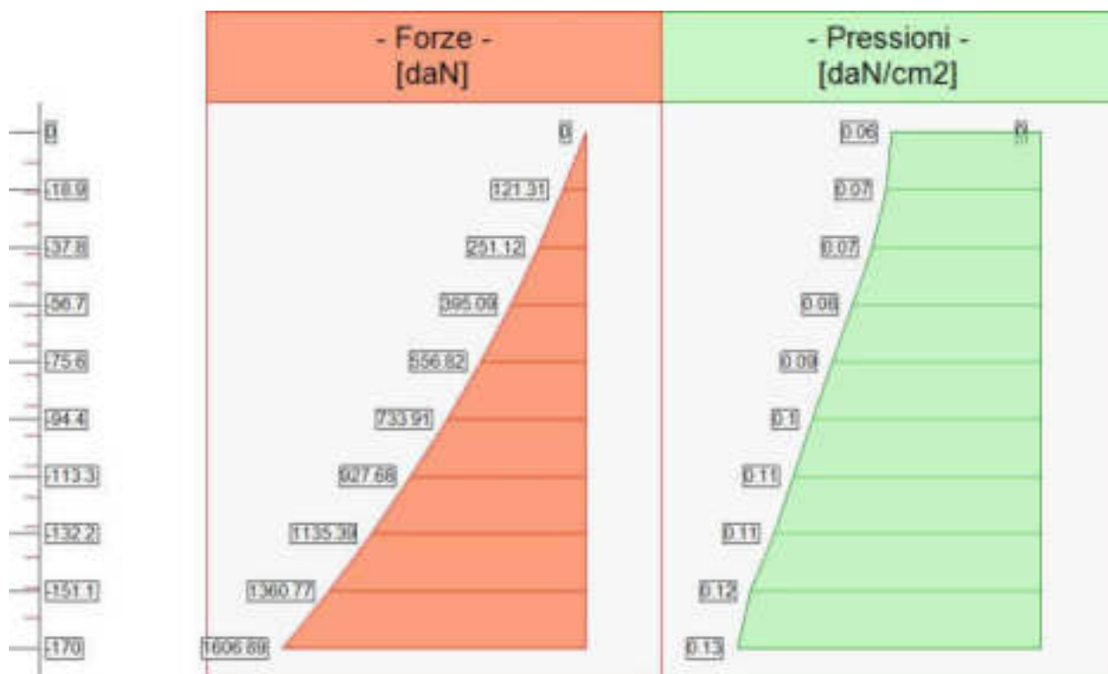
Forze (totali) e Pressioni lungo il fusto, per il Caso 9 ( Q.PERM. [ Quasi_Perm ] - SLE quasi permanente )
