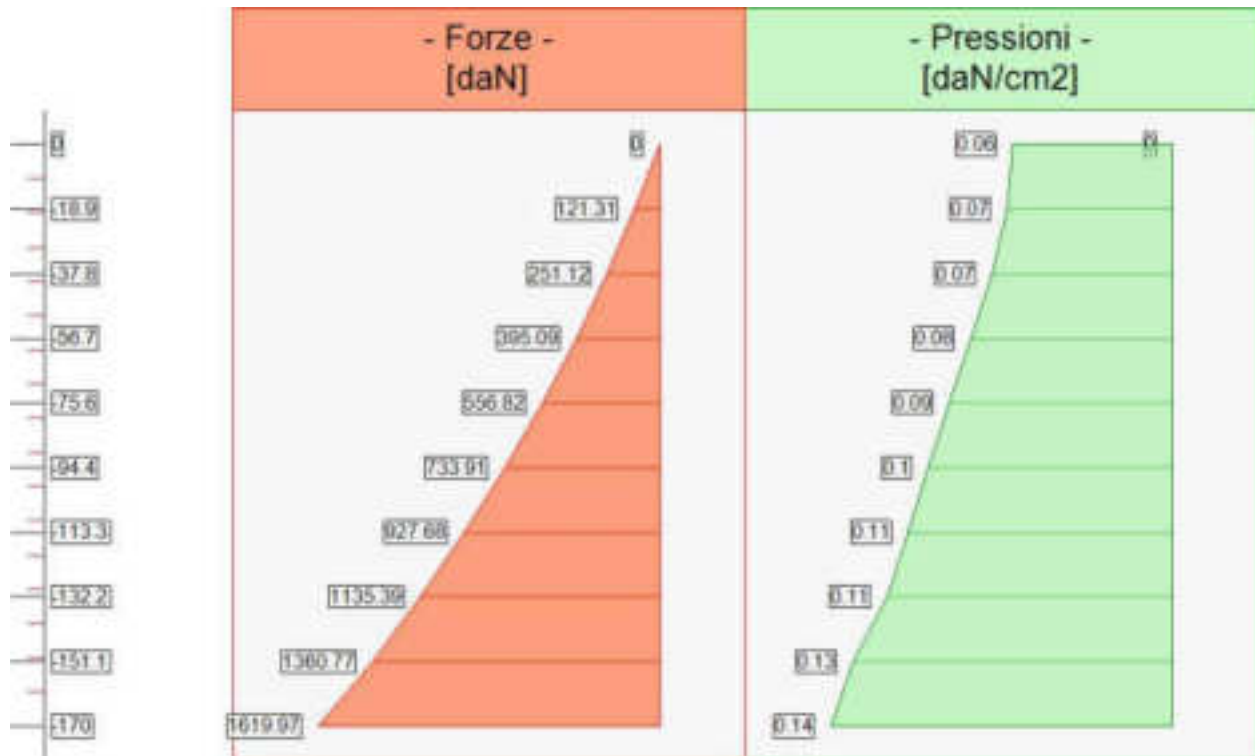
Forze (totali) e Pressioni lungo il fusto, per il Caso 7 ( RARA [ Caratteristica ] - SLE caratteristica (rara) )
