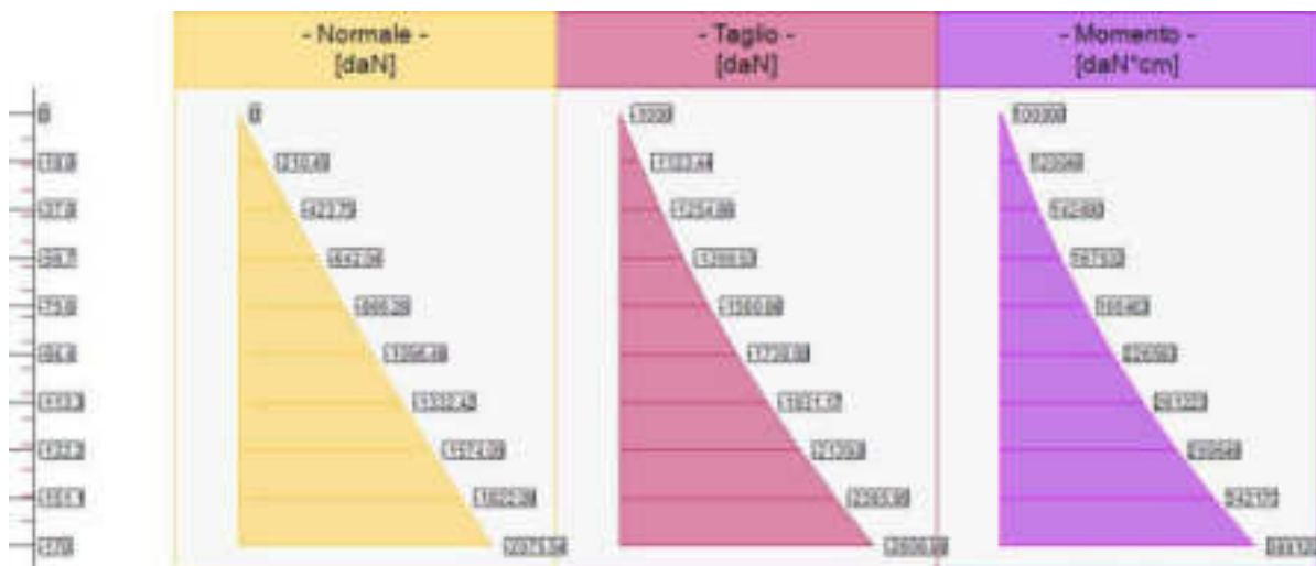
Sollecitazioni lungo il fusto, per il Caso 8 ( FREQ. [ Frequente ] - SLE frequente )
