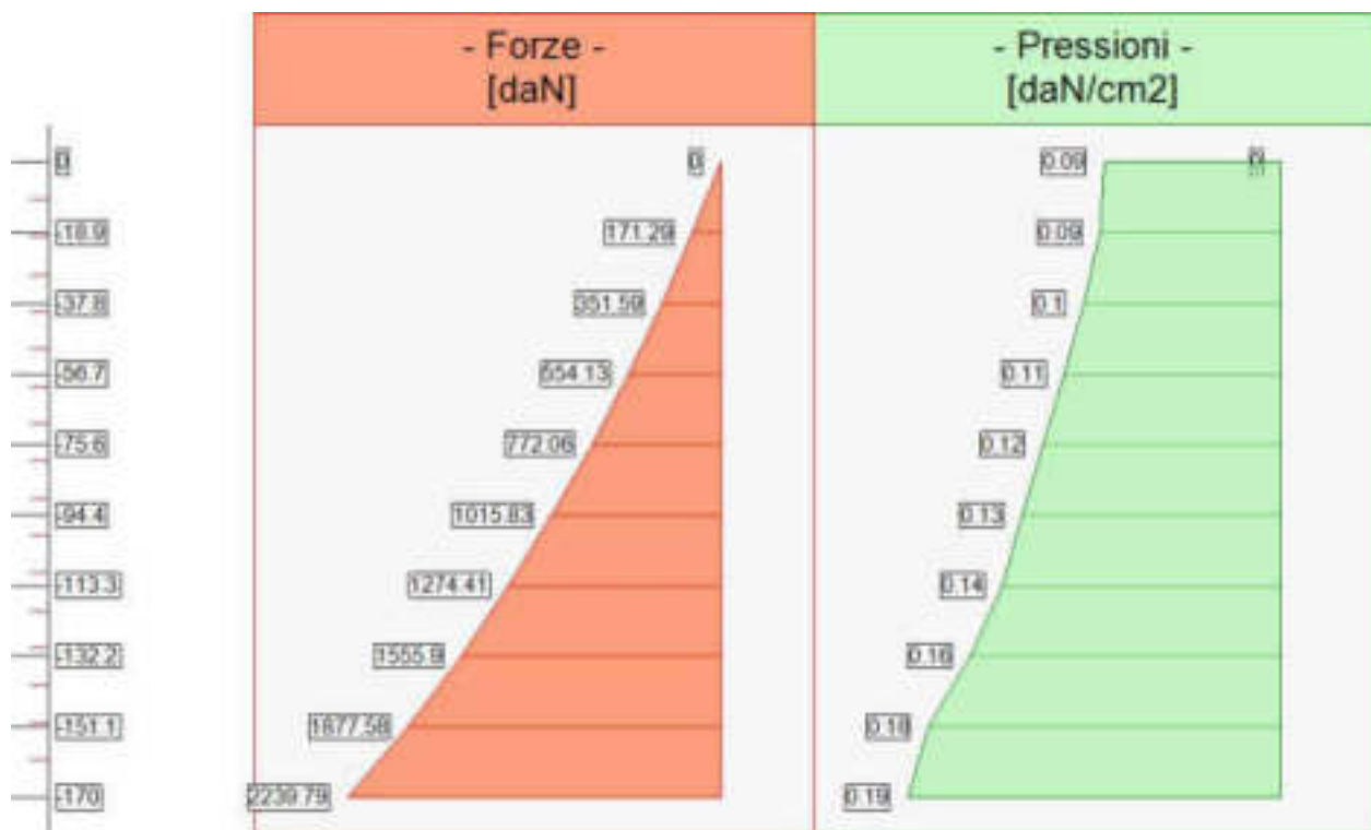
Forze (totali) e Pressioni lungo il fusto, per il Caso 2 ( GEO [ SLU_GEO ] - SLU A2+M2+R2 )
