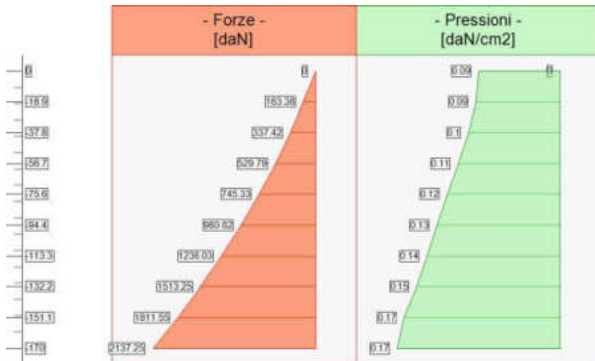
Forze (totali) e Pressioni lungo il fusto, per il Caso 1 ( STR [ SLU ] - SLU A1+M1+R3 )
