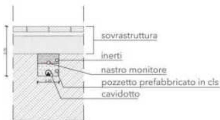
**Figura 5: sezione cavidotto**
